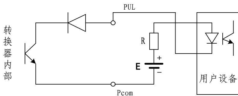
一般，用户光耦需 10mA 左右电流，因此， $E/R=10mA$  左右。 $E=5\sim24V$ 。
