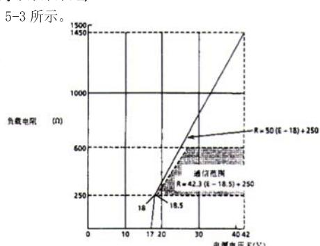
图 5-3 电源电压与负载(4~20mA DC 输出)的关系
