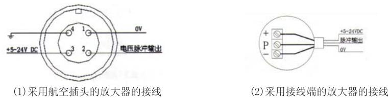
图 5-1 普通脉冲输出放大器接线
