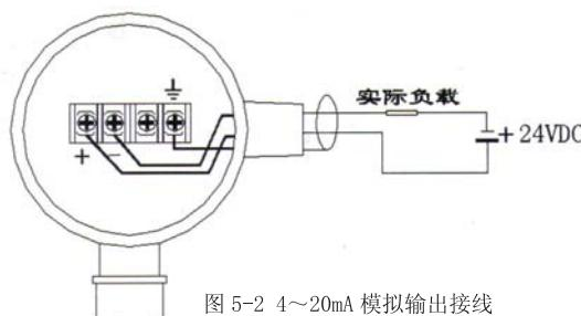
图 5-2 4~20mA 模拟输出接线
