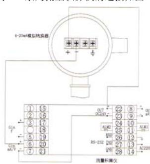
图 5-7 4~20mA 模拟输出转换器与 WP 或 SWP 系列流量积算仪的连接
