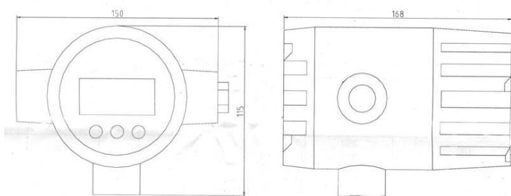
图 4-4 LRT-III型现场显示表外形尺寸
